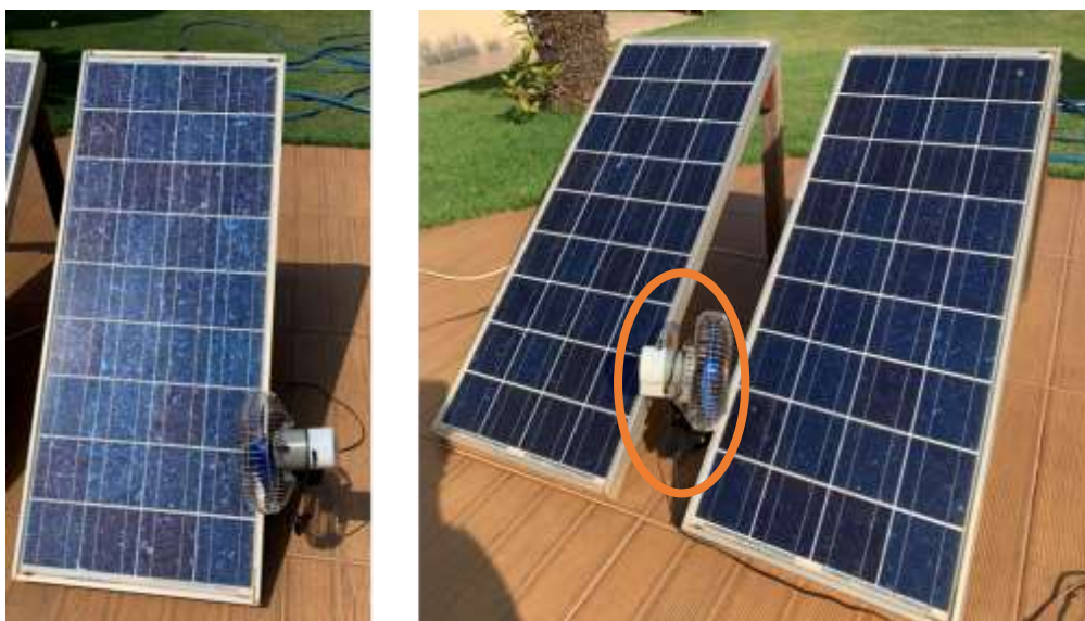
Figura 16 – Posição das placas com o ventilador.
