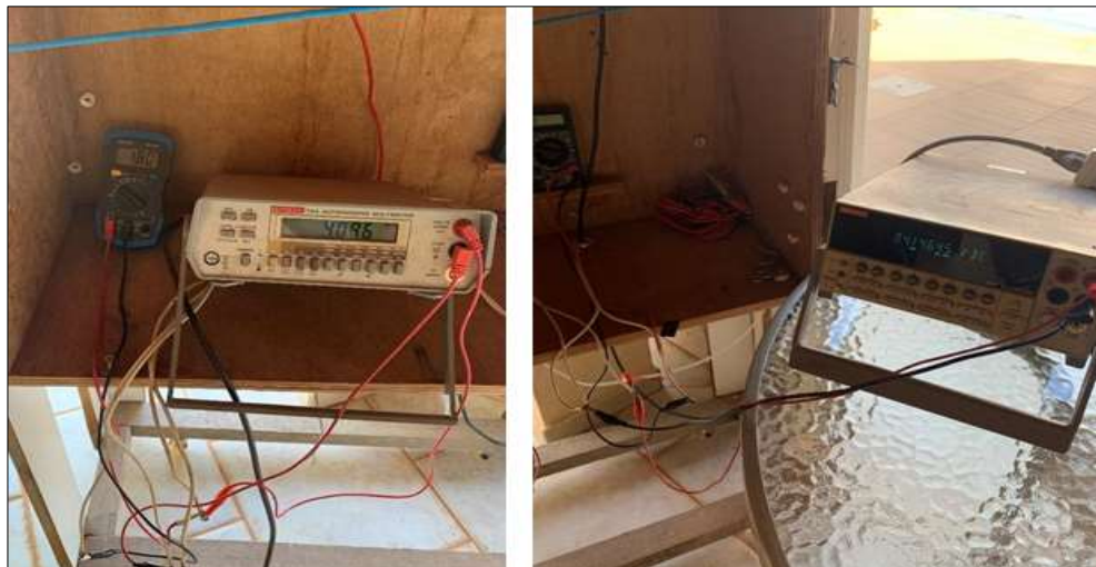
Figura 21 – Arranjo dos multímetros para medições.
