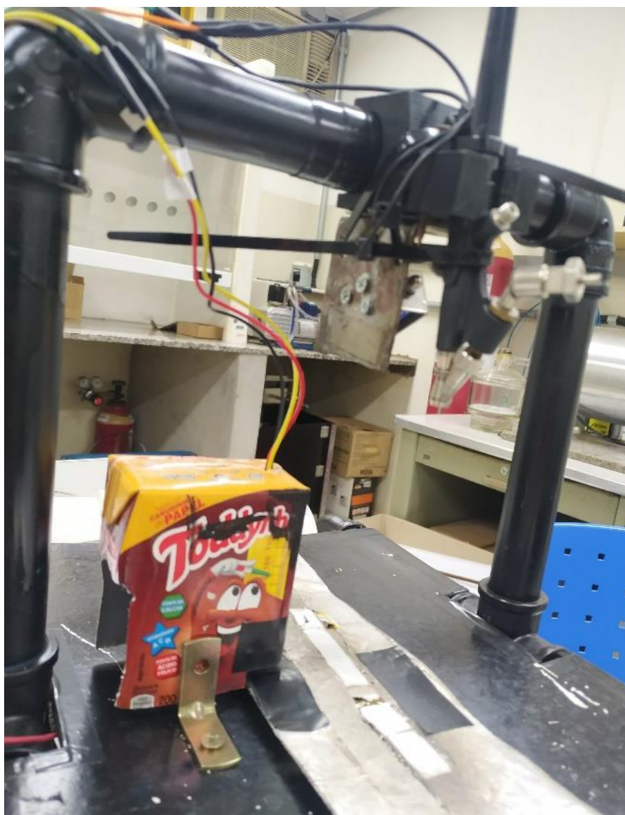
Figura 73 - Montagem da máquina de pintura automatizada.
