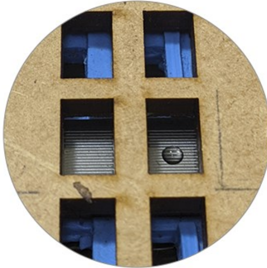
Figura 29 - Gota de água em contato com um sensor durante a coleta de dados. Fonte: próprio autor.
