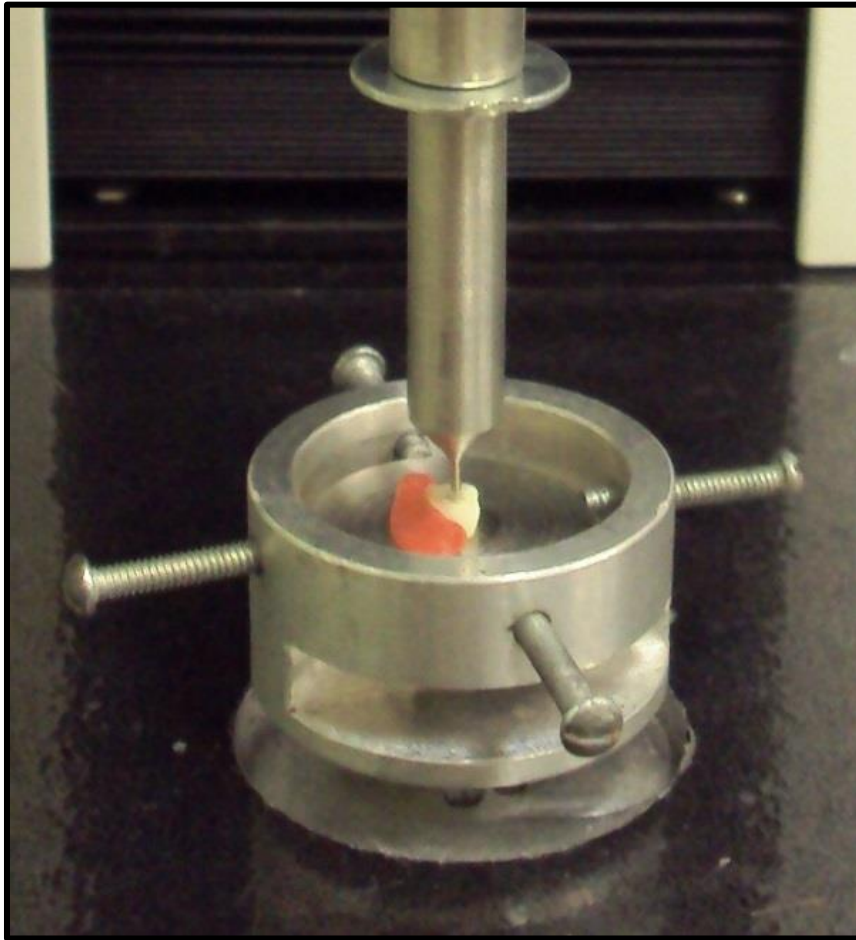
Fotografia 10 - Teste push-out sendo realizado na Máquina de Ensaio Universal Instron 3342 (Instron Corporation, Canton, Massachusetts, EUA).
