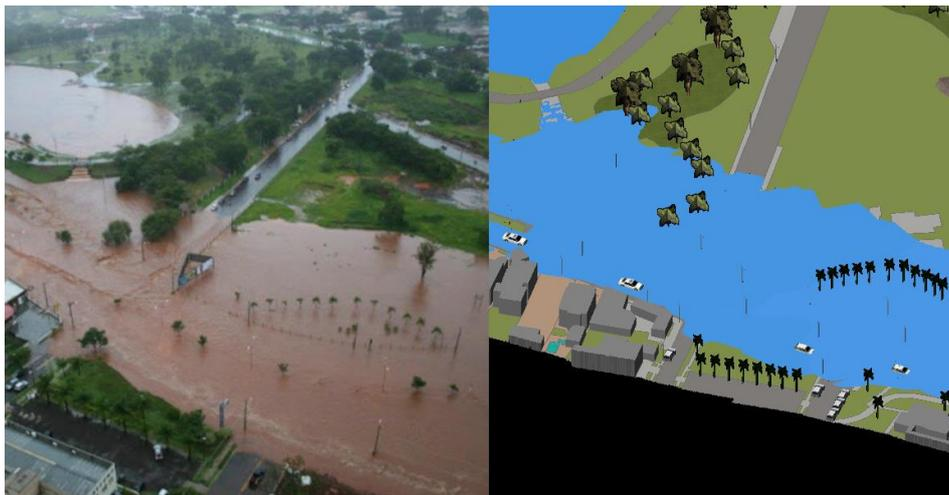
Figura 18 - Comparação de mancha real (esquerda) e computada (direita), para a região da Via Parque. Sem escala. Imagem real reproduzida de Campo Grande News, e computada elaborada pelos autores.
