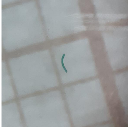
Figura 13: Fotografia de microplástico em papel malhado (1mm) para posterior medição. Fonte: o autor.
