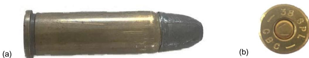
Figura 16: Demonstra uma das munições utilizadas nos ensaios com o revólver calibre .38SPL (*Special*) (a) e em detalhes a sua base (b).
