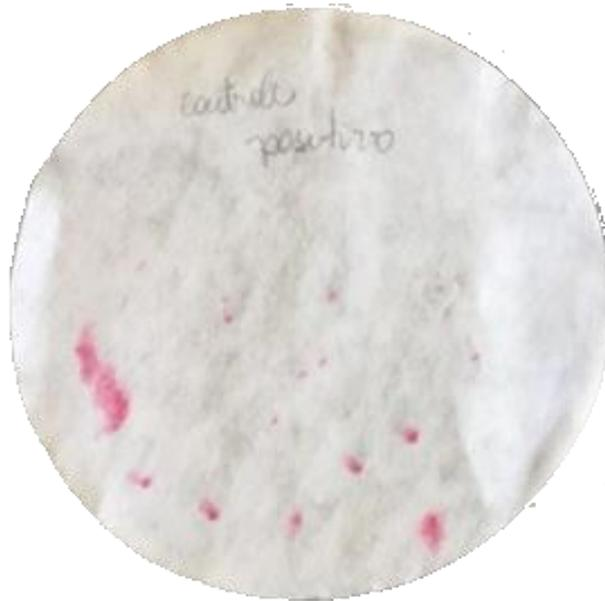
Figura 7 - Demonstra exame residuográfico positivo (área vermelho-purpura) colorimétrico a base de rodizonato de sódio. Fonte: Autor
