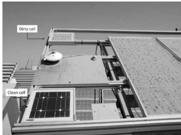
Figura 3.3: A configuração experimental usada nas medições (Zorrilla-Casanova et al., 2011).
