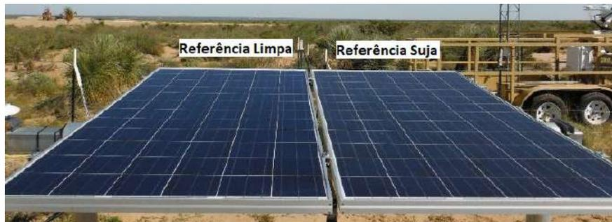
Figura 3.5: Configuração dos dispositivos utilizados por Gostein et al. (2015).
