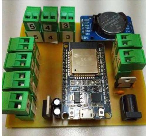
Figura 4.2: Placa para conexão dos dispositivos eletrônicos da estação de sujidade.
