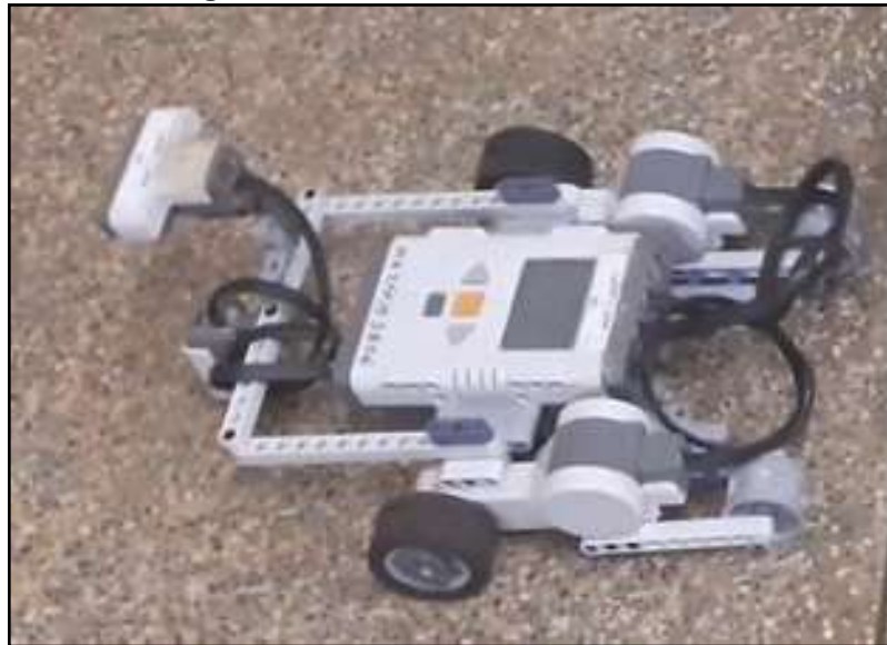
Figura 26 - Robô de desvia de obstáculos
