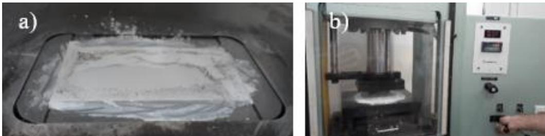
Após a prensagem foram obtidos os CP com dimensões de 105 mm de comprimento, 52 mm de largura e 5,7 mm de espessura, conforme representada na
