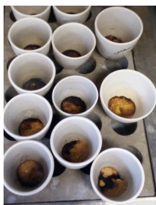
Figura 2 - Cadinhos de porcelana com amostras de carne recebendo aquecimento para queima prévia.
