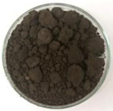
**Figura 4** – Resíduo *Dregs* coletado na indústria de celulose.
