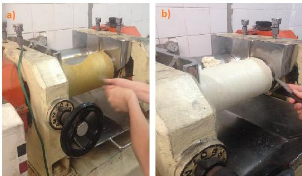
**Figura 5** – a) borracha plastificada e b) borracha com a incorporação dos ativadores.
