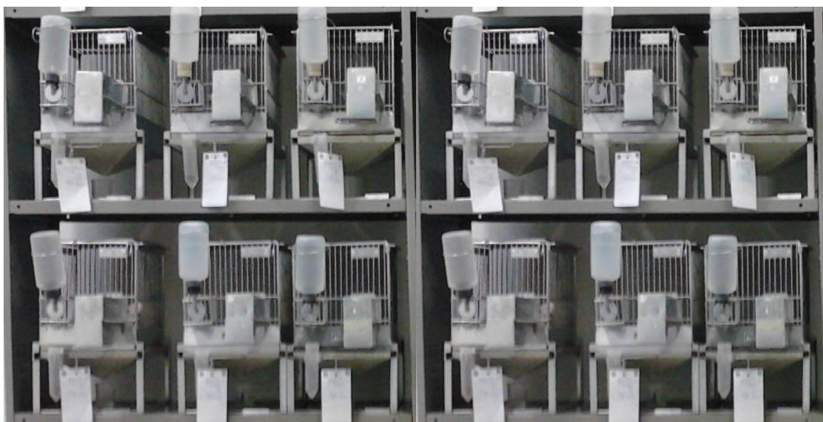
**Figura 05:** Gaiolas metabólicas utilizadas durante experimento *in vivo*
