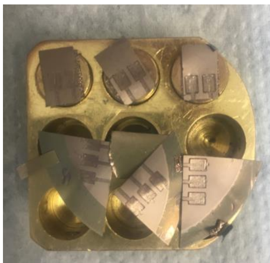
Figura 20. Amostras recobertas por fina camada de ouro.
