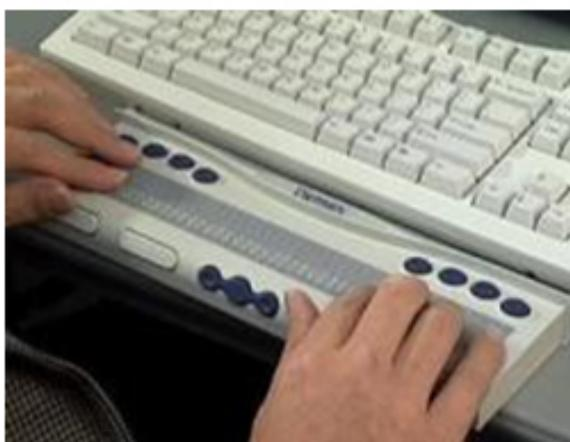
Figura 3 – Exemplo do equipamento Linha Braille
