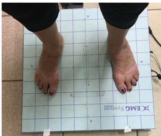
Figura 2: Plataforma de força.
