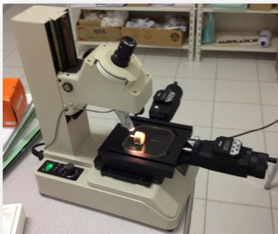
Figura 8 – Corpo de prova posicionado no microscópio com os dispositivos de medida acoplados, para mensuração da fenda na interface I-P.
