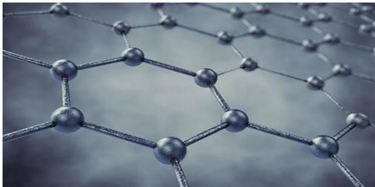
Figura 5: Representação da estrutura atômica (cristalina) do grafeno: uma única folha de átomos de carbono ligados entre si. Imagem retirada de [33]
