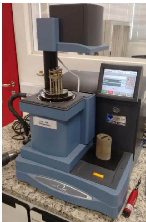
Figura 15 - Equipamento utilizado para realizar os ensaios de análise dinâmico-mecânica.
