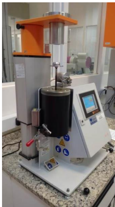
Figura 12 - Equipamento utilizado nos ensaios para determinação do índice de fluidez (MFR).
