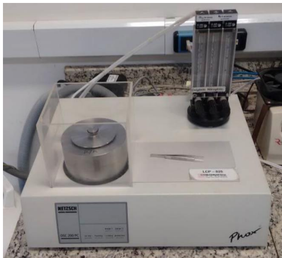
Figura 11 - Equipamento utilizado para os ensaios de determinação de OIT.
