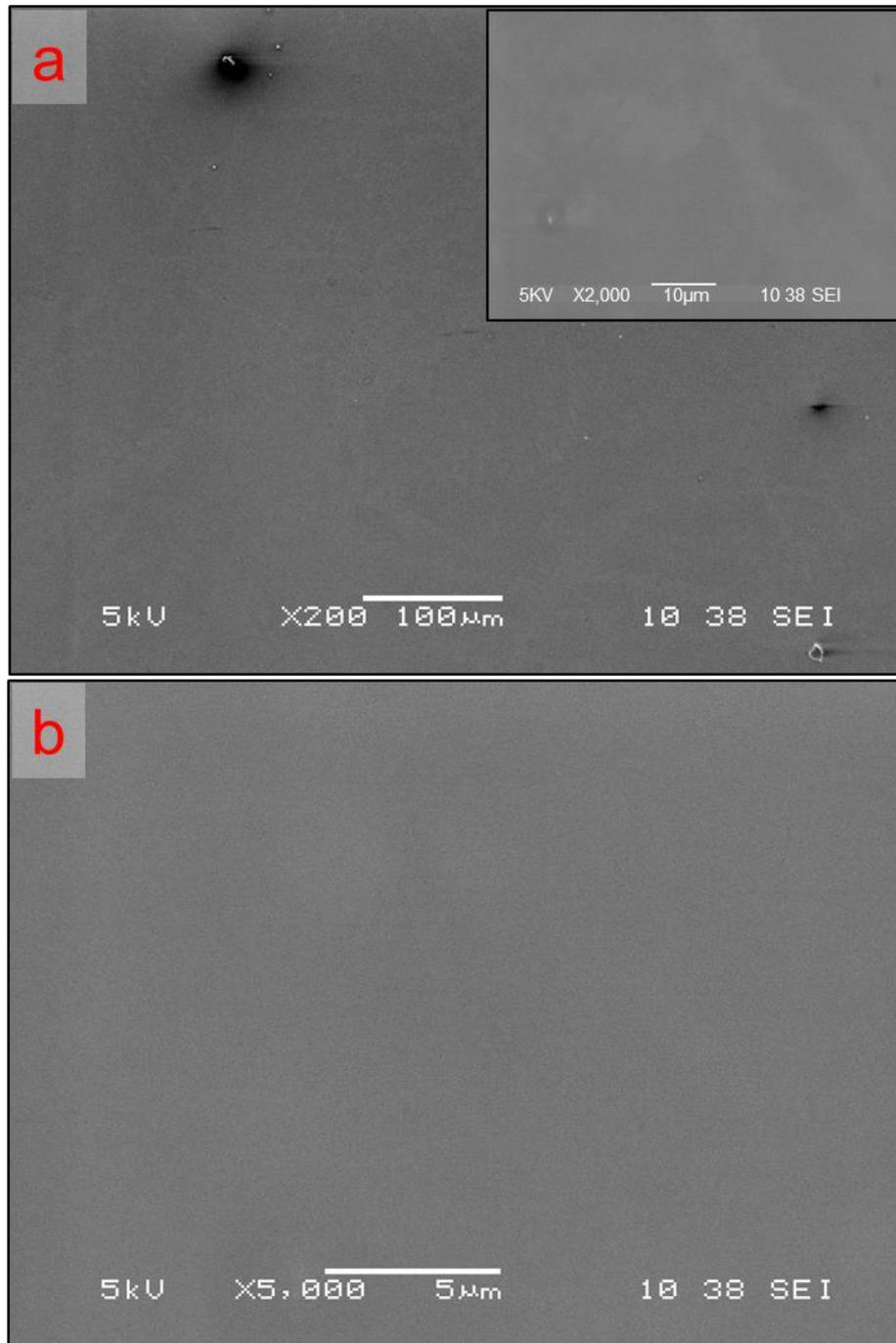
Figura 6.5 - Imagens de MEV da amostra 2, com as magnificações: a – 200X detalhe no *inset* onde foi realizada a magnificação, b – 5000X.
