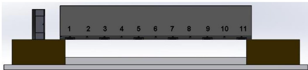
Figura 86 - Marcação dos pontos de medição no módulo 1, corte no meio do módulo representados pelo plano “A” – Vista frontal.
