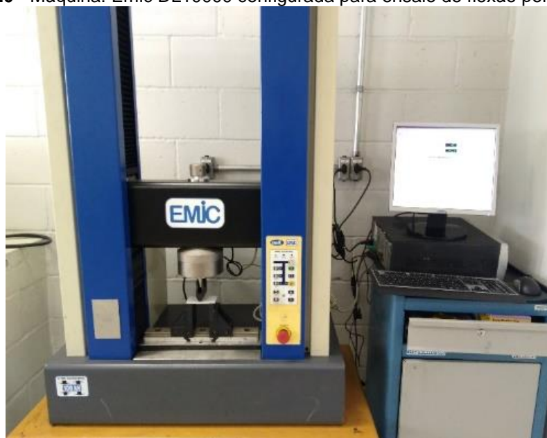
Figura 20 - Máquina: Emic DL10000 configurada para ensaio de flexão por 3 pontos.
