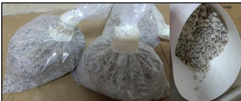
Figura 13. Farinha da amêndoa de bocaiuva obtida de frutos desidratados a 40, 50, 60 e 70 °C e armazenados por 120 dias.
