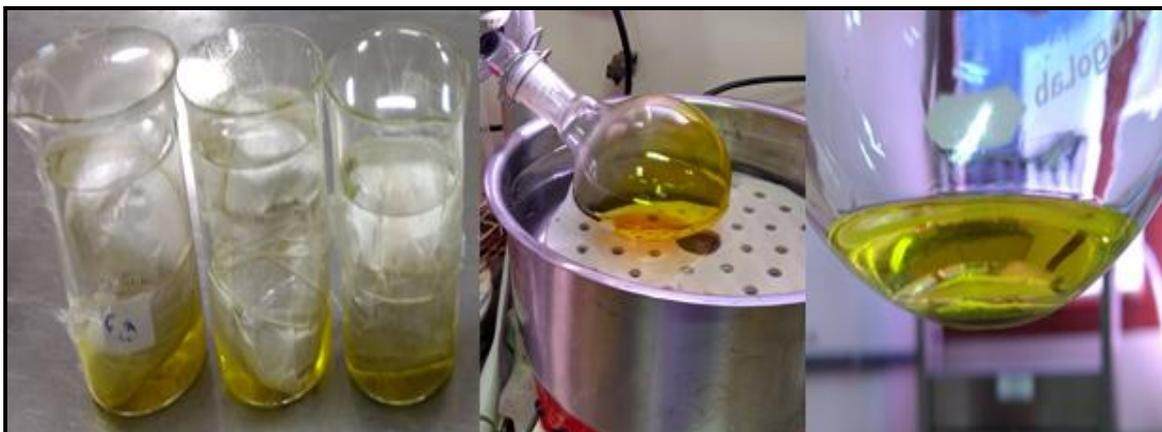
Figura 18. Extração dos lipídios da polpa de bocaiuva.
