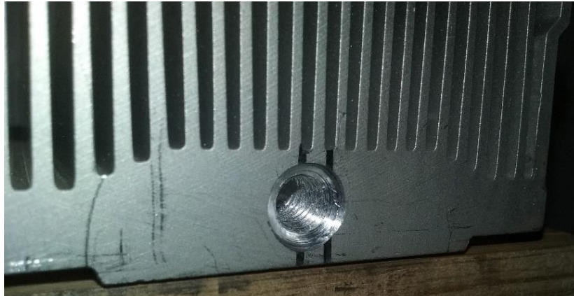
Figura 29 – Dissipador de calor com furo lateral para instrumentação
