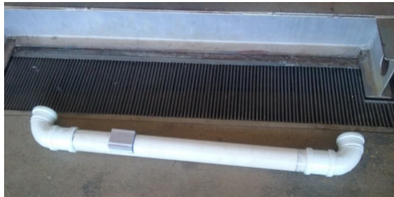
Figura 31 – Dissipador de calor encaixado no cano de PVC
