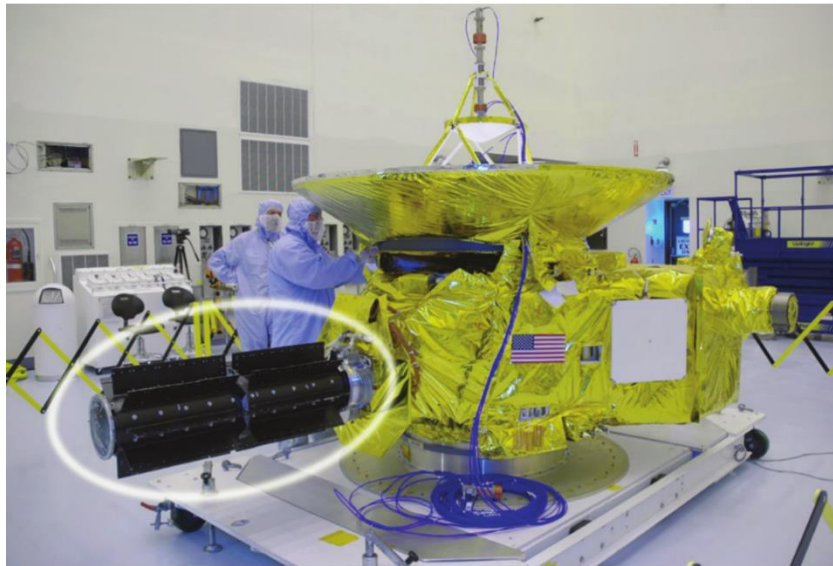
Figura 2 – MMRTG a bordo da espaçonave New Horizons
