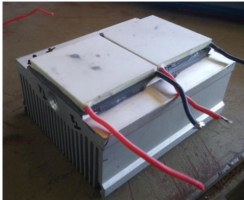
Figura 30 – Módulos termoeletrônicos sobre o dissipador de calor
