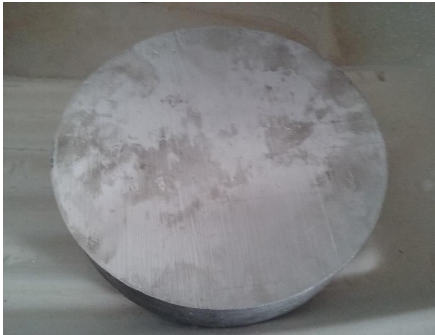
Figura 25 - Tarugo de alumínio utilizado no desenvolvimento do coletor de calor
