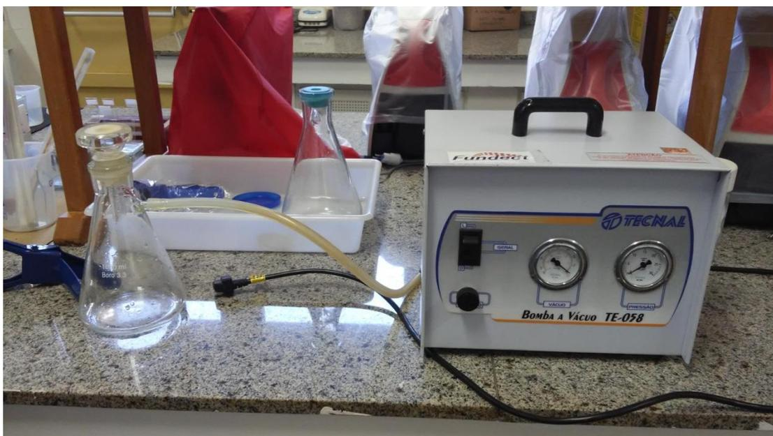
**Figura 21.** Bomba a vácuo da marca TECNAL, modelo TE-058.
