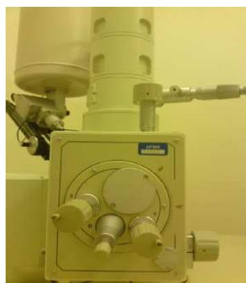
Figura 7 - Coluna ótico-eletrônica, detector e câmara de amostras.
