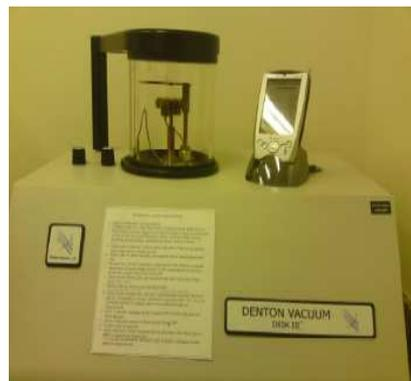
Figura 5 - Equipamento utilizado para deposição metálica sobre as amostras.
