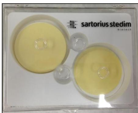
**Figura 17:** Microfiltros utilizados para pesagem dos sedimentos.
