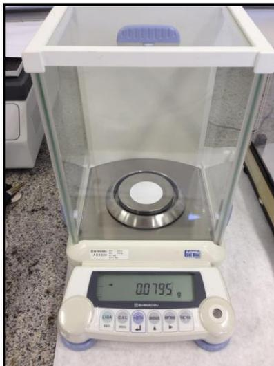
**Figura 18:** Pesagem dos filtros antes da filtração.
