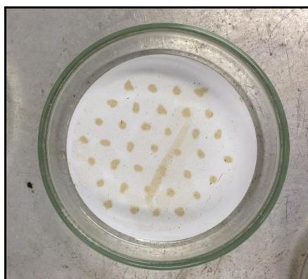
**Figura 21:** Microfiltro com sedimentos após a filtração da amostra.
