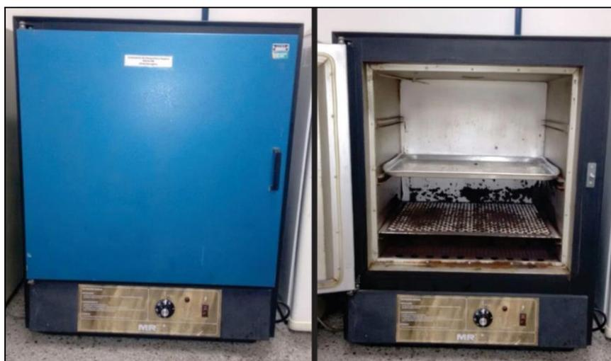
**Figura 22:** Secagem dos microfiltros em estufa.
