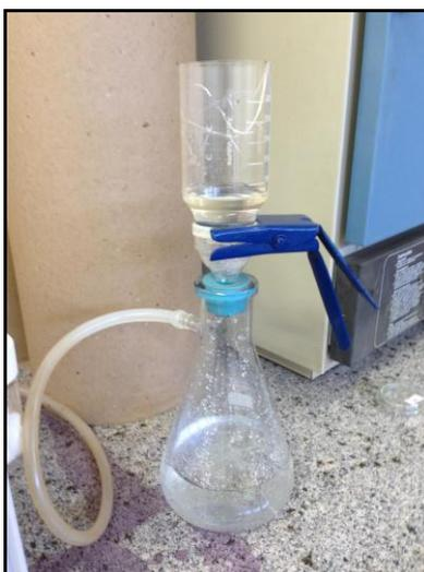
**Figura 19:** Instrumentos usados para filtração da água.
