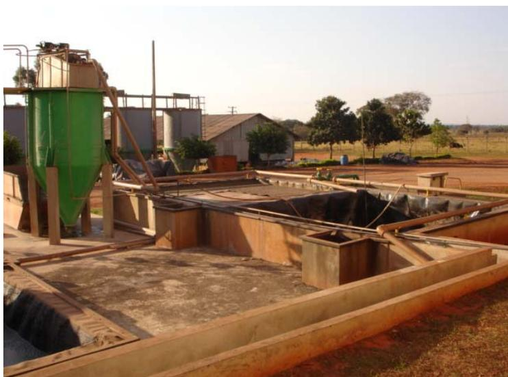
FIGURA 4.1 – Sistema de reciclagem de banho de caleiro.
