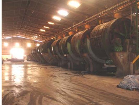
FIGURA 3.3 – Fulões: reatores de batelada utilizados no processo.
