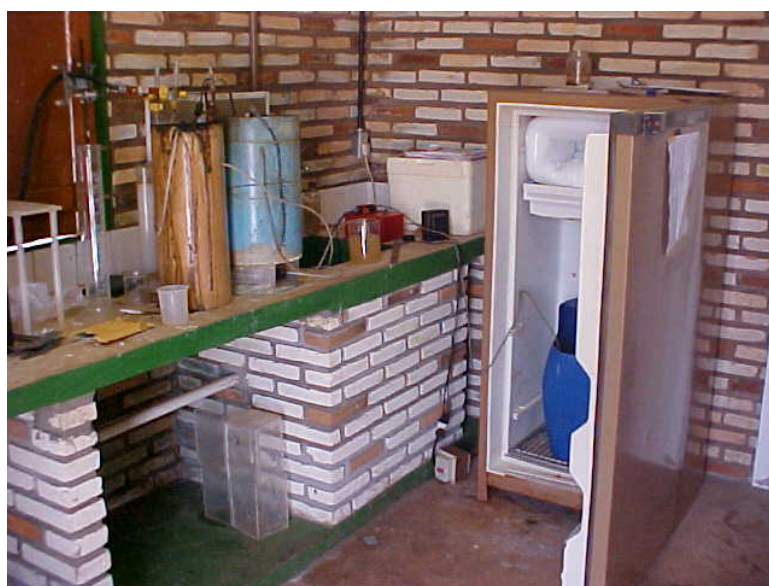
Figura 4.7. Acondicionamento do efluente para alimentação dos reatores.
