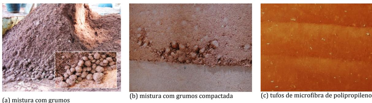
Figura 41: Heterogeneidade na superfície da parede.
