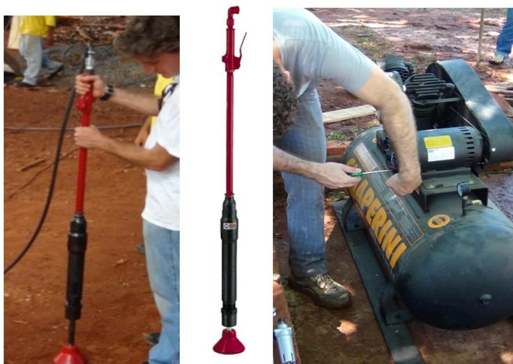
Figura 49: Compactador pneumático e compressor
