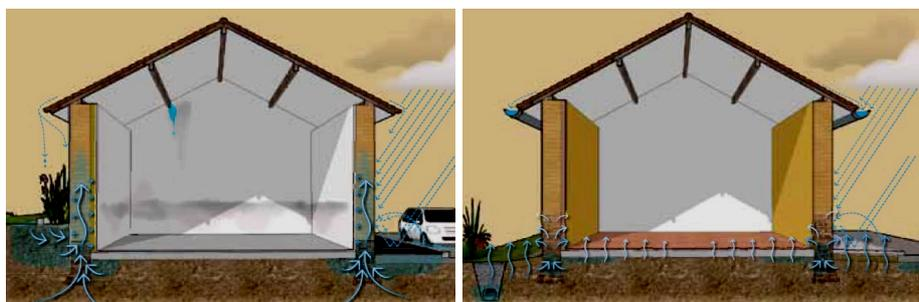
Figura 15: Ações da umidade em paredes de taipa
