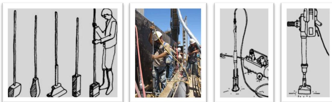
Figura 8: Tipos de compactadores: manuais, pneumáticos e mecânico
