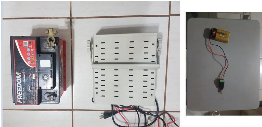
Figura 23 – Bateria automotiva e seu carregador versus bateria comum 9V
