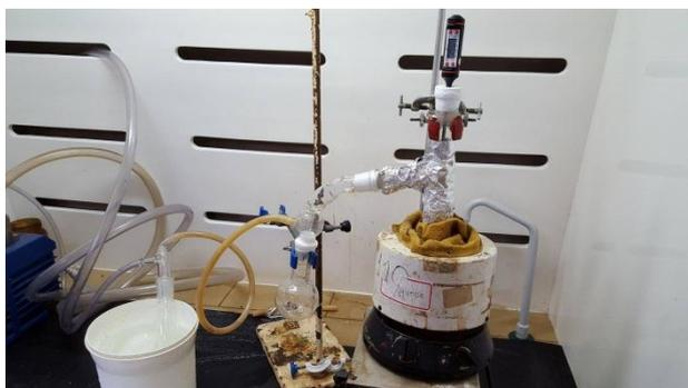
**Figura 7** – Sistema de destilação do LCC.
