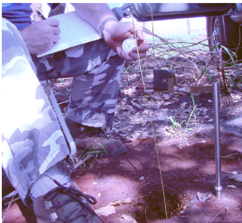
Figura 4.3: Teste de determinação da condutividade hidráulica.
