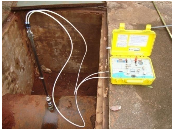
Figura 4.2 – Medidor de Vazão.
