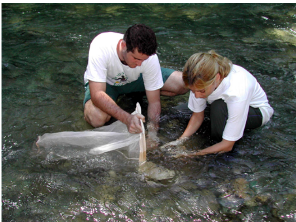
Figura 4.2 - Coletando com o amostrador Surber.
