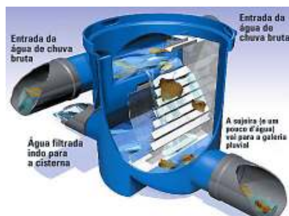
Figura 3.19: Filtro para água de chuva bruta. Fonte: Acqua Save On Line, s.d.
