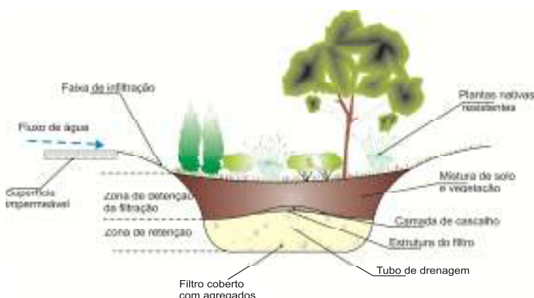
Figura 4.20: Esquema de Bioretenção
