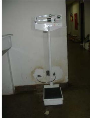
Figura 20 - Balança mecânica adulta (150 Kg)
