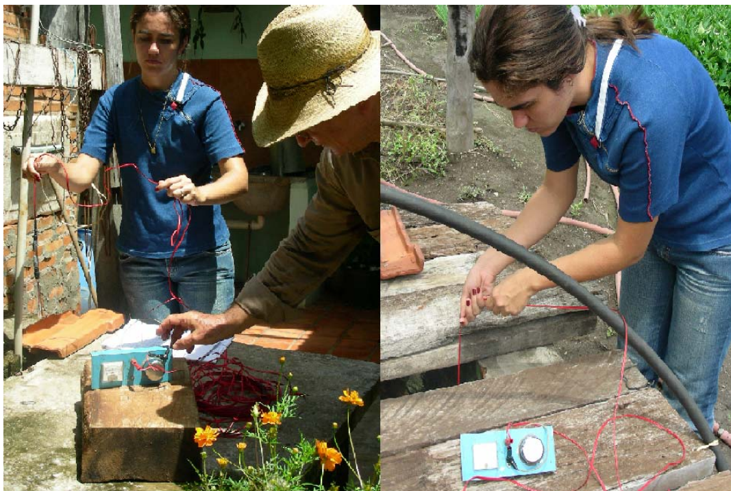
FIGURA 4.7 – Detalhe do medidor elétrico de nível d'água.
