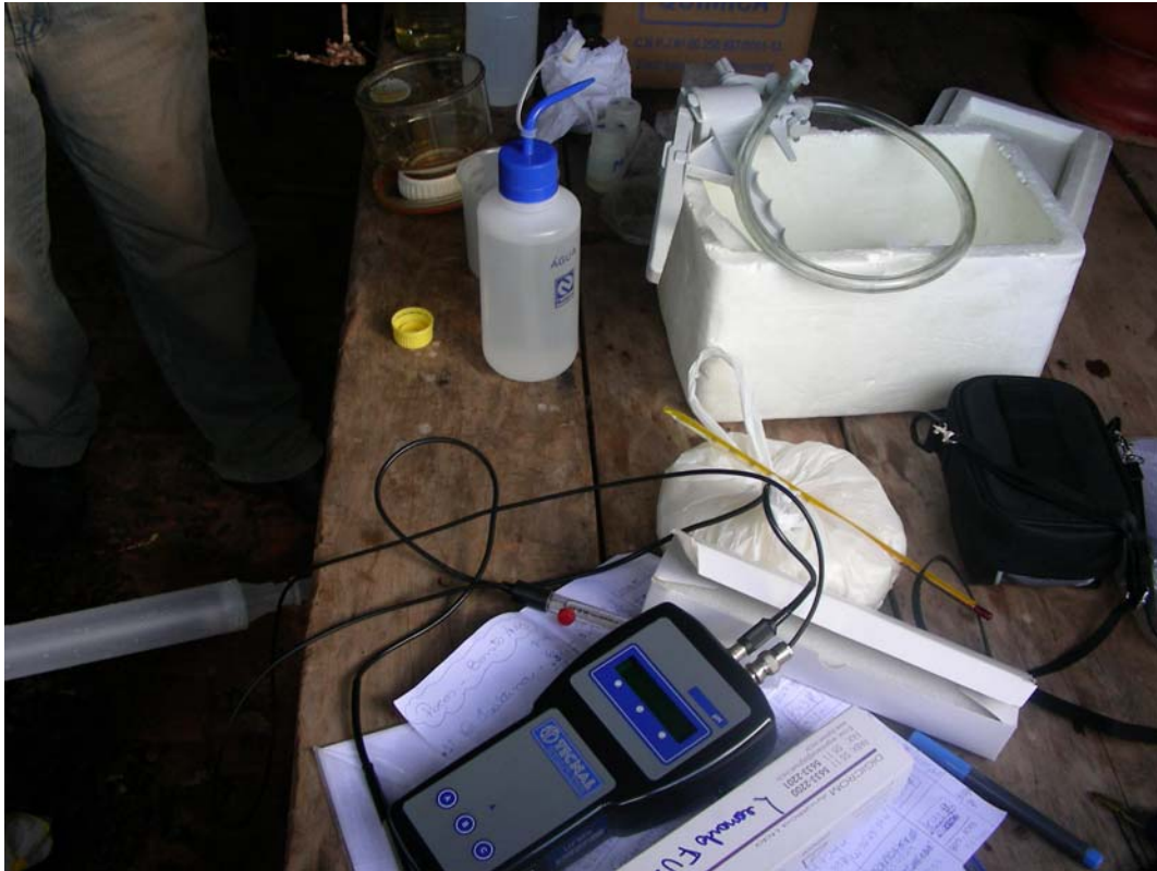
FIGURA 4.11 – Materiais para análise no campo de pH e temperatura.
