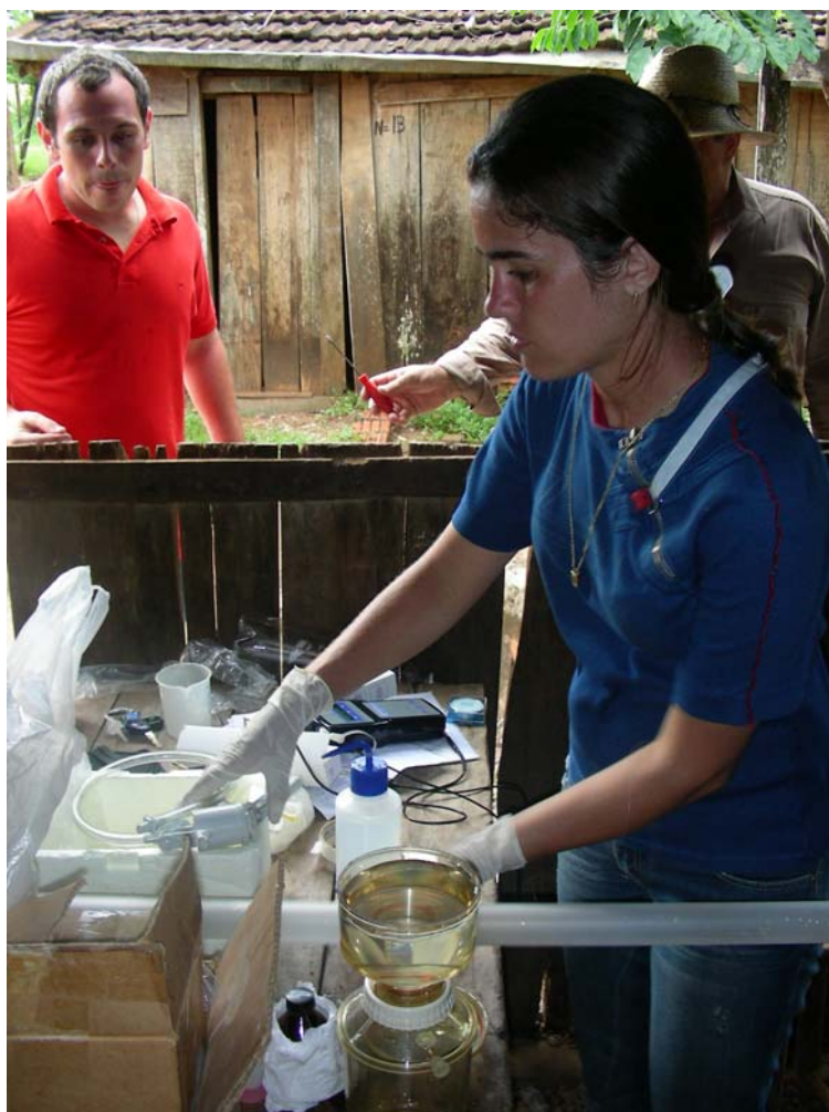
FIGURA 4.10 – Filtração a vácuo das amostras de água, realizada no campo.
