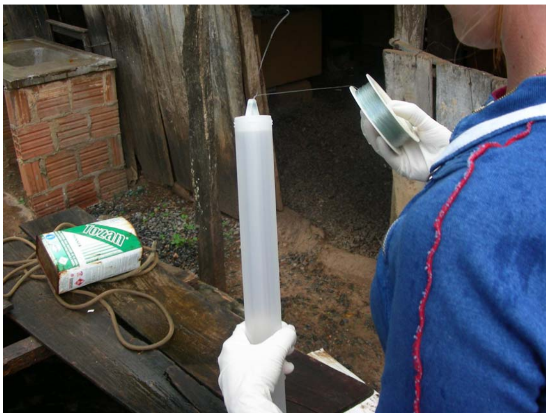
FIGURA 4.9 – Pesquisa de campo: Amostrador descartável
