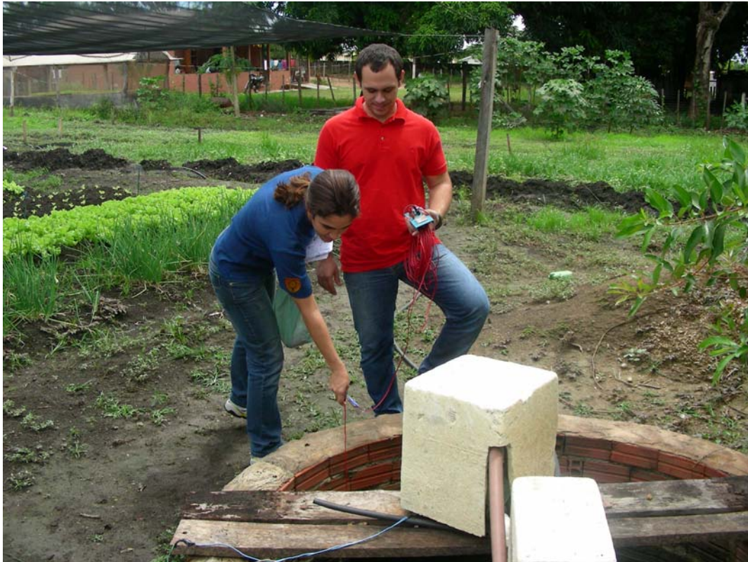
FIGURA 4.6 – Determinação do nível d'água no poço, com utilização de medidor elétrico.
