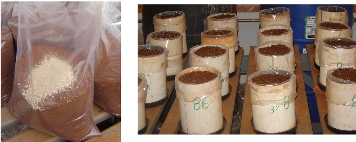
Figura 4.2 – Mistura do lodo com solo, em saco plástico, e disposição do mesmo nos vasos de PVC.
