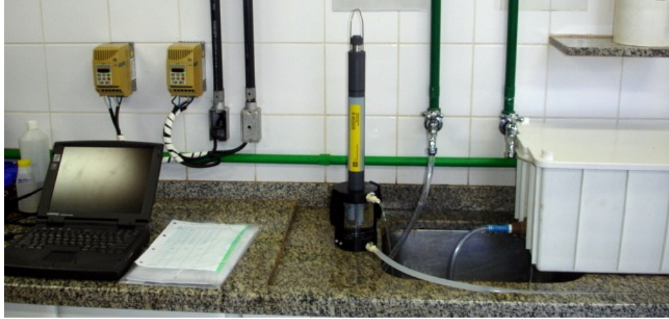
Figura 5.8 - Calibração dos sensores da sonda.
