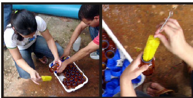
Figura 5.20 - Preparação dos frascos (teste de decaimento de cloro).
