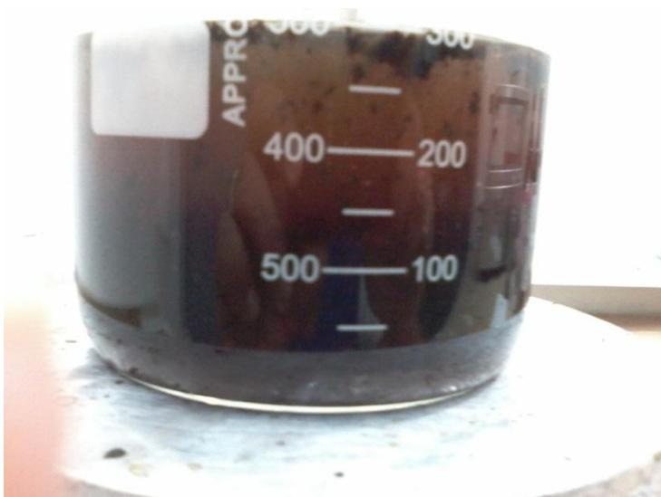
Figura 15: Foto do sólido obtido depois de seco na estufa a 50 °C chamada de grafeno expandido.
