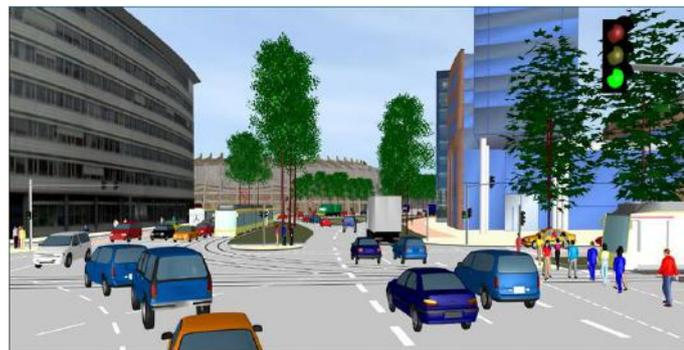
**Figura 3.20:** *VisSim - pode-se observar a simulação com diferentes tipos de veículos, como também o fluxo de pessoas. Os veículos podem trafegar por várias faixas e obedecer certas políticas semafóricas [4]*
