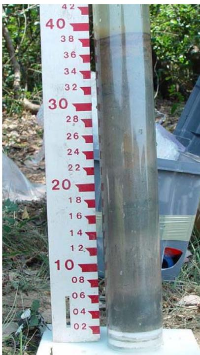
**Figura A1. Amostra de sedimento coleta pelo amostrador “Core”.**
