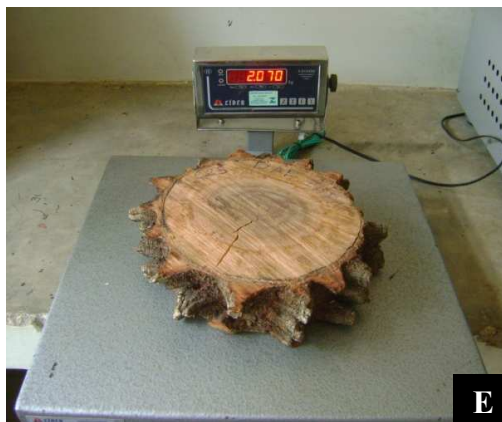
Figura 2. (A) Pesagem à fresco dos galhos e (B) troncos, sendo posteriormente secos em estufa de ar forçado (C) à 60°C as folhas e (D) à 40 °C os discos dos troncos e posteriormente pesados (E).
