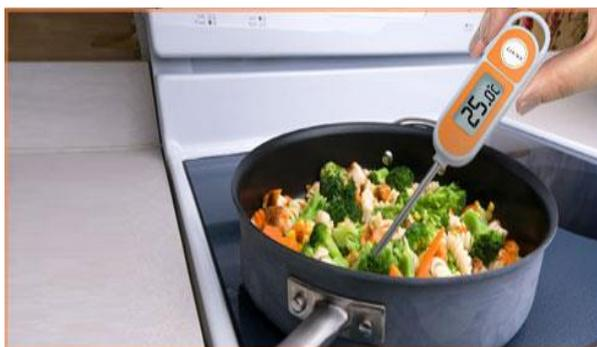
**Figura 14** - Termômetro do tipo espeto. <http://www.solucoesindustriais.com.br>. Acesso em 26/06/2014.
