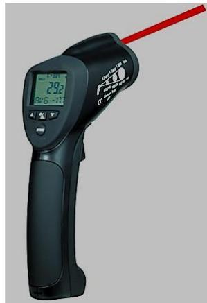
**Figura 13** - Pirômetro. FONTE: [www.quimicambientalust.com.br](http://www.quimicambientalust.com.br). Acesso (26/06/2014).
