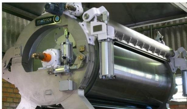
**Figura 46** - Secador de cilindro. Disponível em: [www.motrice.com.br](http://www.motrice.com.br). Acesso em: 20/09/2014.
