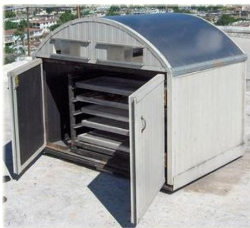
**Figura 33** - Desidratador solar. Disponível em [www.cubasolar.cu](http://www.cubasolar.cu). Acesso em: 19/09/2014.
