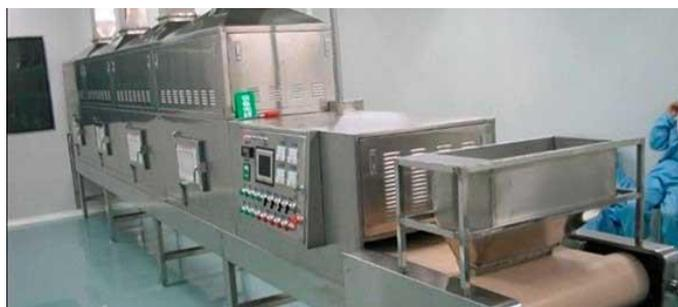
**Figura 49** - Secador de esteira a vácuo. Disponível em: [www.manutencaosuprimentos.com.br/](http://www.manutencaosuprimentos.com.br/). Acesso em: 22/09/2010.
