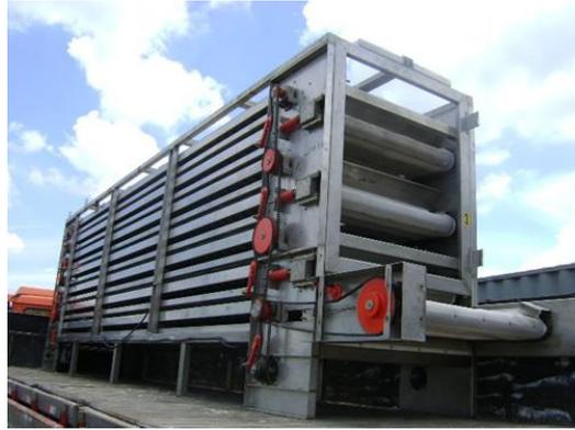
**Figura 41-** Secador do tipo forno. Disponível em: [www.forteusi.com.br](http://www.forteusi.com.br). Acesso em 22/09/21014.
