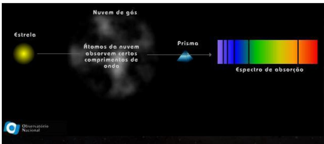
Figura 06: Esquema de produção de um espectro de absorção
