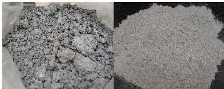
FIGURA 4.1 – Resíduo de curtume antes e após a moagem e peneiramento
