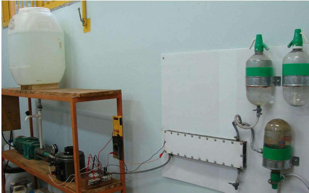
**Figura 4.6.** Conjunto de alimentação elétrica da câmara de reação eletroquímica.
