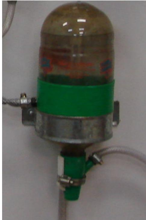
**Figura 4.5.** Câmara de contato/decantação do sistema eletrolítico.
