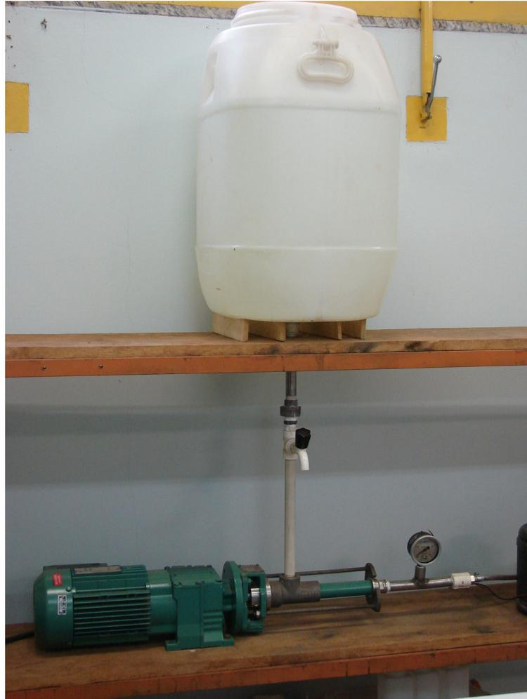
**Figura 4.1.** Sistema de alimentação do conjunto experimental.
