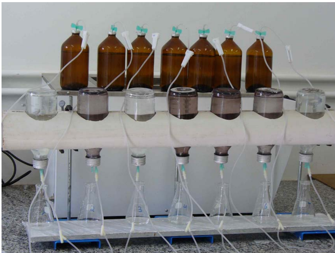
FIGURA 4.3 – Leitura da produção de \text{CH}_4 pelo método da medição direta do volume de metano.
