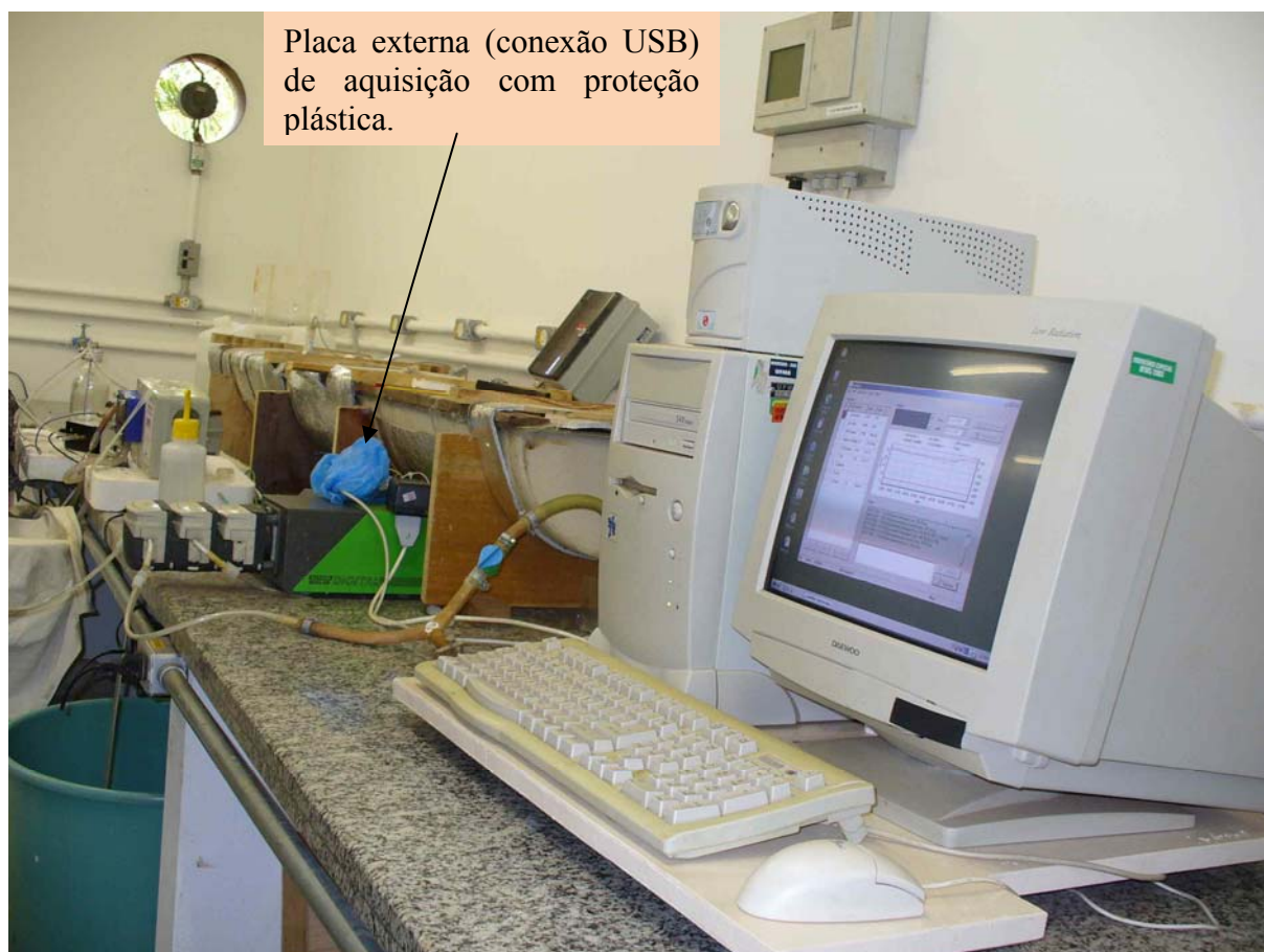
FIGURA 4.8 – Sistema de monitoramento on line .
