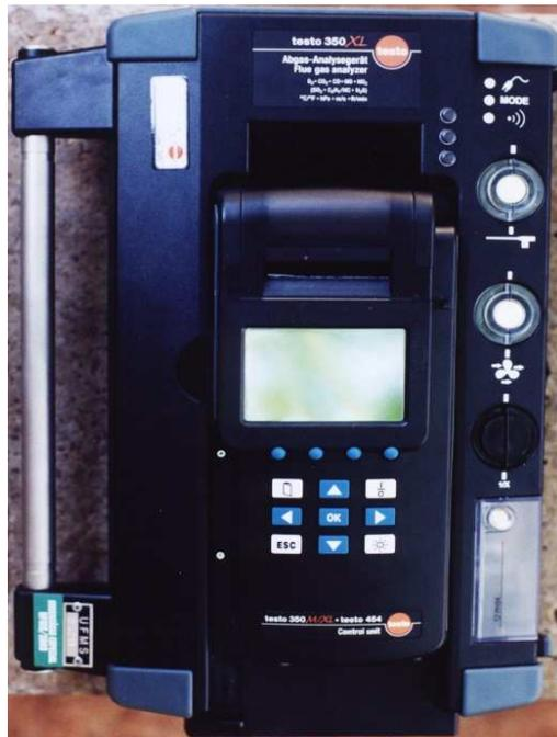
**Figura 4.3– Analisador de poluentes atmosféricos da TESTO – 350 XL.**
